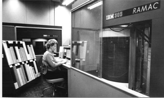
El antecesor del disco duro que conocemos hoy día. Fue introducido en 1956 como parte del RAMAC de IBM (Método de Acceso Random de Contabilidad y Control). Podía almacenar 5MB de datos en 50 discos de 24 pulgadas de diámetro. El disco rígido tenía el tamaño de una heladera, y la unidad entera, pesaba más de una tonelada (como los de hoy en día, que entran en el bolsillo, ¿no?).
