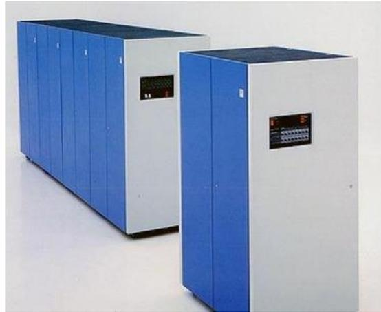
En esta ocasión, IBM llegó a el gigabyte en almacenamiento con la introducción en 1980 del disco IBM 3380 de acceso directo.
