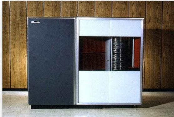
IBM reemplazó a la larga el modelo RAMAC con el sistema de almacenamiento de disco 1301. Lo estrenó en 1961, y utilizaba cabezas separadas para escritura y lectura en cada superficie, eliminando la necesidad de correr el cabezal cada vez que necesitaba acceder a un disco diferente.
