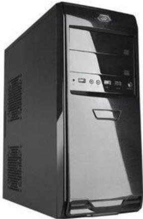
El case o el gabinete de la PC; es **el componente donde se instalan todas las partes internas de la computadora**, como la fuente de poder, tarjeta madre, procesador entre otros.
