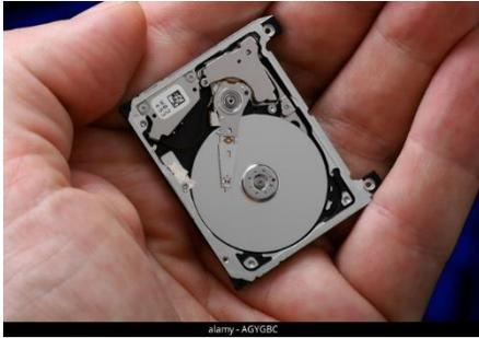
**El micro disco IBM:** tenía platos de una sola pulgada e diámetro, con un mecanismo que podría ser insertado en un Slot Compact Flash tipo II
