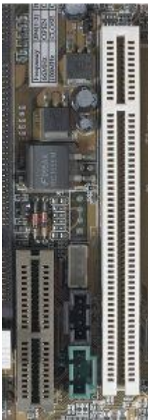
Audio/modem rise (izquierda) junto a una ranura PCI (derecha)
