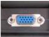
Se trata de un conector semitrapezoidal con 15 terminales, que se encarga de enviar las señales referentes a los gráficos desde la computadora hasta una pantalla para que sean mostrados al usuario.
