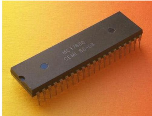
Por último, os traemos un socket extraño para los usuarios, el DIP (Dual in-line package), que viene a ser un empaquetado de doble hilera. Es una forma de encapsulamiento en circuitos integrados que consiste en un chip con pines a ambos lados (dos hileras), cuya separación es de 2.54 mm.
