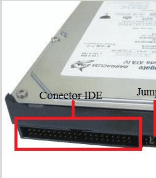
LA INTERFAZ IDE/ATA O PATA (PARALLEL ATA) ES UN ESTÁNDAR DE INTERFAZ DE CONEXIÓN DE DISPOSITIVOS DE ALMACENAMIENTO MASIVO DE DATOS.
