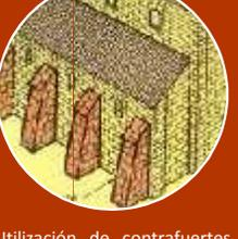
Utilización de contrafuertes. El contrafuerte está unido al muro y su principal función es reforzar el muro.
