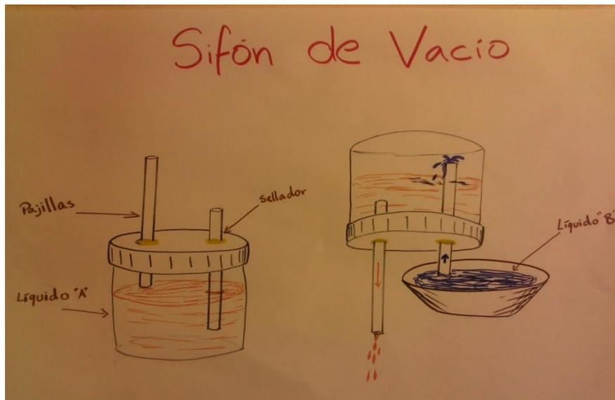
Como resultado, el agua pura comenzará a salir y el agua teñida entrará automáticamente. La presión atmosférica ejercida sobre el agua teñida empuja el agua hacia adentro del recipiente. El vacío en el interior permite que el agua teñida entre y a la vez que el agua pura salga por la otra pajilla.
