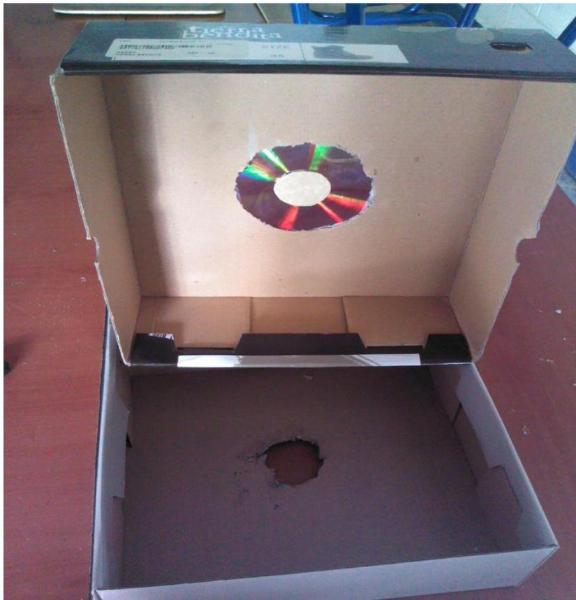
4. Corta un agujero en la parte posterior de la caja, exactamente detrás de donde colocaste el DVD, tal como se ve en la imagen anterior. El agujero debe ser lo suficientemente grande para que entre y salga con facilidad la linterna que vas a utilizar.
