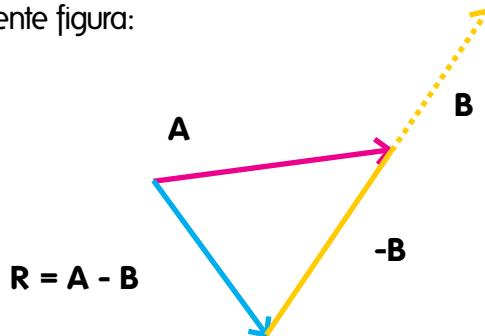
Se tomó el vector **A**, a continuación el vector **-B**. La resultante se obtiene uniendo el origen de **A** con la punta de **-B** (choque de cabezas).
