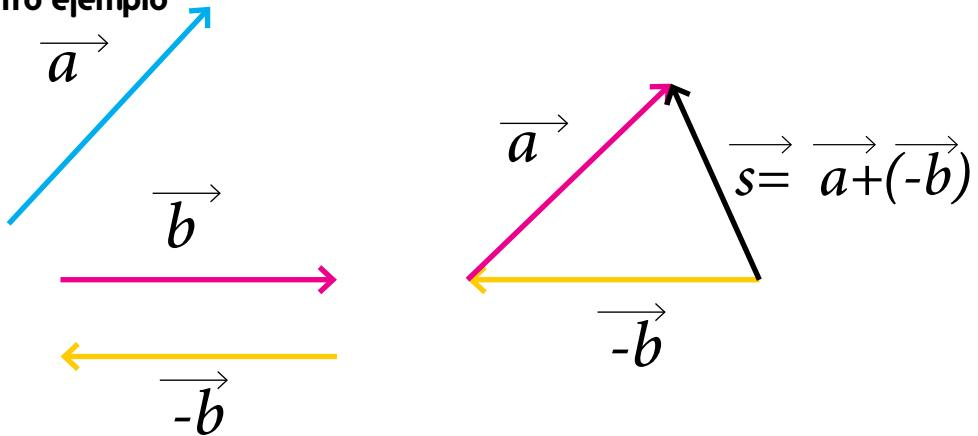
Se tomó el vector **-b**, se unió con el vector **a**. El vector **S**, resultante se obtiene uniendo el origen de **-b** con la cabeza de **a** (choque de cabezas).
