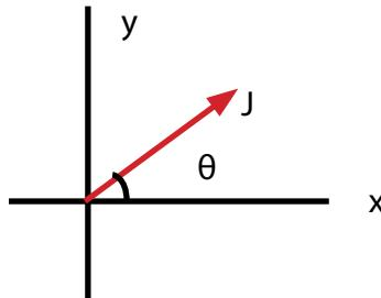
Si se une cada eje por medio de una línea perpendicular desde el final del vector, se forma un triángulo  $ABC$ , en donde el lado  $AB$  es la componente en  $X$  ( $J_x$ ) del vector, y el lado  $BC$  es la componente en  $Y$  ( $J_y$ ) del vector. Le hemos llamado  $J$  al vector y por eso sus componentes se identifican
