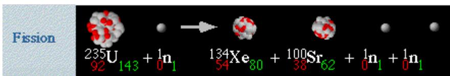
En las **centrales nucleares** el proceso se modera, evitando la reacción en cadena, para generar energía de forma lenta, pues de lo contrario el reactor se convertiría en una bomba atómica. Cuando se consigue que sólo un neutrón de los liberados produzca una fisión posterior, el número de fisiones que tienen lugar por segundo es constante y la reacción está controlada, evitando así que la reacción sea una gran explosión.
