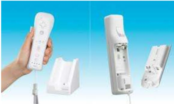
las baterías, es común que los aparatos incorporen un diagrama que muestre cómo deben colocarse; así mismo, los contactos se distinguen empleándose convencionalmente un muelle metálico(resorte) para el polo negativo y una placa para el polo positivo. En los aparatos con baterías recargables, el transformador-rectificador tiene una salida
