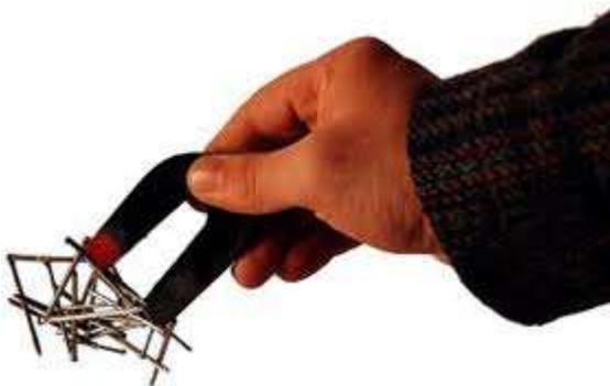
Se llama imanes a todo aquel cuerpo capaz de producir un campo magnético propio, de forma tal que atraiga al hierro, el cobalto y el níquel. Este material presenta una mayor capacidad de atracción sobre sus extremos.
