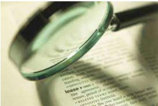
Comúnmente se utiliza para examinar detalles de objetos, para leer impresos con caracteres de letra muy pequeños, etc. La imagen lograda con una lupa es virtual, mayor y de igual sentido que el objeto observado. En la lupa simple, disminuye la distancia focal y, por lo tanto, la amplificación aumenta, pero también aumentan las aberraciones (distorsiones) esféricas, por lo cual siempre debe restringirse el campo
