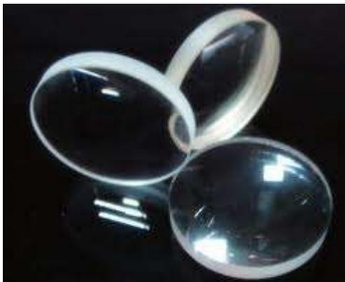
Se llama lente a un medio transparente limitado por caras curvas o por una plana y otra curva. En sistemas ópticos, es un disco de vidrio u otra sustancia transparente cuya forma hace que refracte la luz procedente de un objeto y forme una imagen real o virtual de éste.
