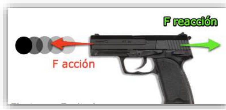
Al golpe dado con la culata de un arma, se le llama culatazo, es el efecto que el retroceso del arma tiene sobre quien dispara. Se trata de una aplicación de uno de los principios más básicos de la mecánica, el de acción y reacción.
