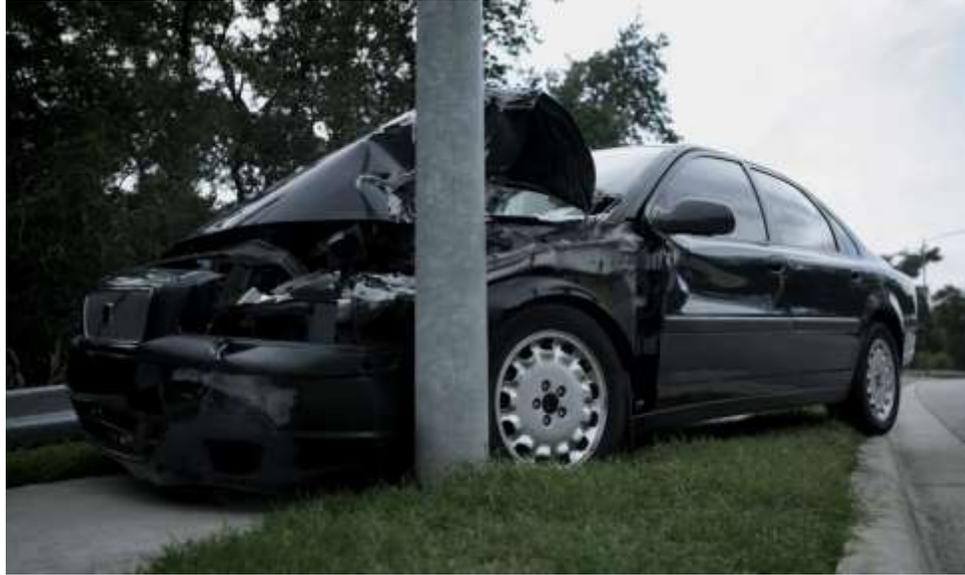
cuerpos. Esto quiere decir que la energía cinética, en general, antes del choque es mayor que la que tiene después. La pérdida de energía que tiene lugar en la colisión se invierte en deformar los cuerpos, en calor o en energía potencial de deformación.
