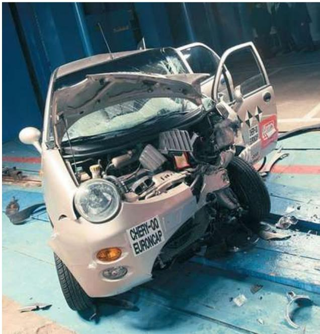
Cuando el choque es descentrado, la estructura del vehículo se ve sometida a un mayor esfuerzo, puesto que toda la fuerza de la colisión se concentra en una zona más pequeña que en el caso de la colisión 100% frontal. La energía de la colisión es absorbida por menos elementos resistentes y, por tanto, sufren una mayor deformación, ya que los elementos del lado opuesto del choque no se ven afectados y no intervienen en el proceso de absorción de energía.
