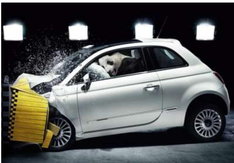
Cuando el choque es totalmente frontal, la estructura alcanza una menor deformación, puesto que la fuerza de la colisión se reparte en toda la superficie del frontal y, por tanto, actúan todos los elementos resistentes de la estructura de igual forma.
