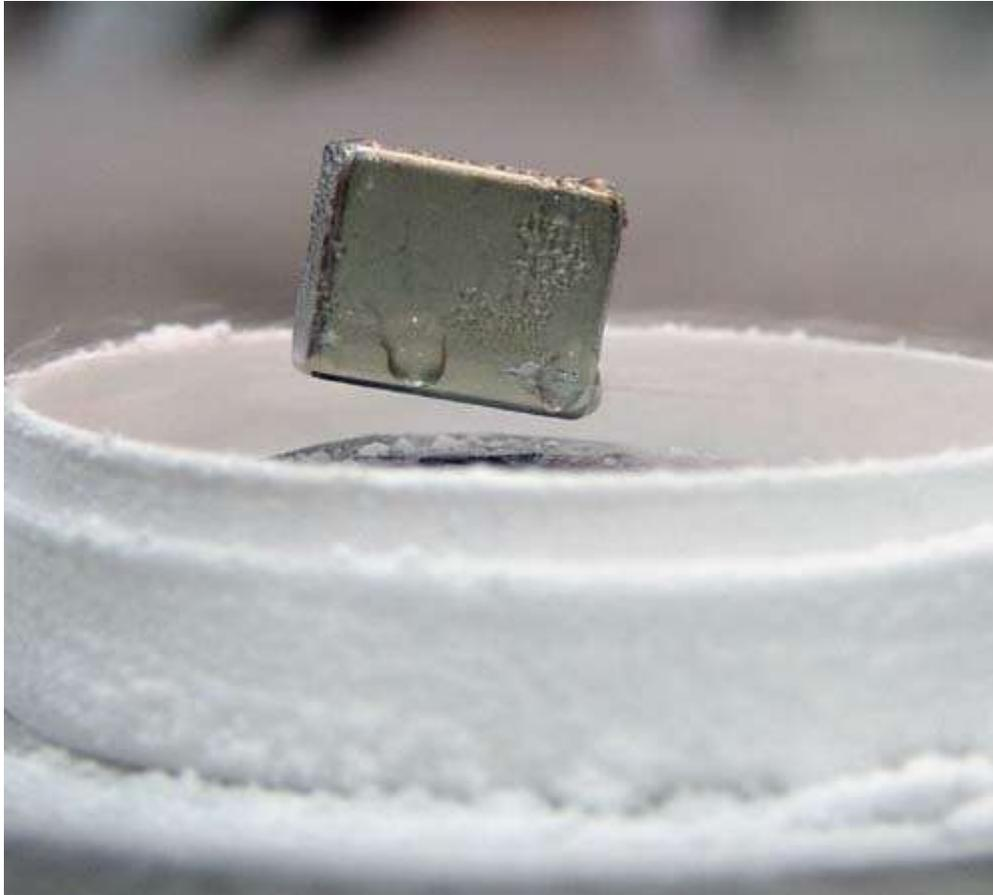
Superconductor: Se denomina superconductividad a la capacidad que poseen ciertos materiales para conducir corriente eléctrica sin resistencia y pérdida de energía nulas en determinadas condiciones. En este caso es la ausencia de resistencia al magnetismo.
