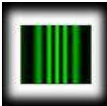
Al hacer incidir (entrar) luz solar sobre el orificio de la primera pantalla, la luz difractada iluminaba los orificios de la otra pantalla, originando dos nuevos haces luminosos que eran recibidos en otra pantalla, pudiendo observarse franjas luminosas intercaladas con oscuras, las cuales se originan por la interferencia entre las ondas luminosas.
