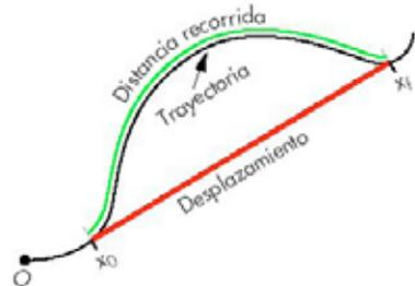
Solo existe un caso en que ambos conceptos son prácticamente iguales: el movimiento rectilíneo. En efecto, en este tipo de movimiento, como la trayectoria es una línea recta, el desplazamiento se confunde con la trayectoria. Un ascensor tiene movimiento rectilíneo hacia arriba o hacia abajo.
