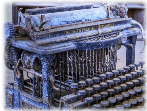
En 1833, se concedió una patente francesa al inventor Xavier Progin por una máquina que incorporaba por primera vez uno de los principios utilizados en las máquinas modernas: el uso para cada letra o símbolo de líneas de linotipia separadas y accionadas por palancas. El mecanismo utilizado para mover el papel era un rodillo cilíndrico que sujetaba firmemente el papel y se movía horizontalmente para producir el espaciado entre líneas.
