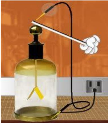
Es un aparato que permite averiguar si un cuerpo está eléctricamente cargado o no lo está. Se compone de una botella de vidrio, un tapón de goma por cuyo centro pasa una varilla metálica que tiene, en uno de sus extremos, una pelotita metálica y en el otro, dos laminas de oro o platino que, al cargarse, por contacto o por inducción, se repelen (se separan).
