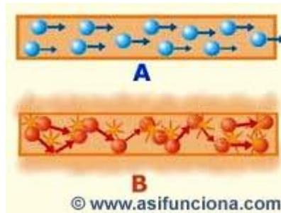
A. Electrones fluyendo por un buen conductor eléctrico, que ofrece baja resistencia.
