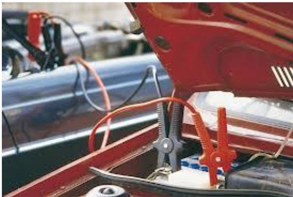
auto, ahí sí debes cuidar la polaridad porque el diseño de la alimentación directa así lo requiere (polo negativo hacia positivo). De hecho la mayoría de los aparatos en casa utilizan corriente directa para operar, pero tú los conectas a la **corriente alterna** porque los aparatos, internamente, tienen convertidores que hacen que esa **corriente alterna** se convierta en corriente directa.
