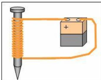
Un electroimán es un imán cuyo **campo magnético** se produce mediante el paso de una corriente eléctrica. Esto es, un imán accionado por electricidad.
