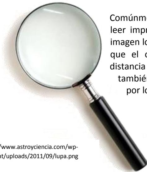
Comúnmente se utiliza para examinar detalles de objetos, para leer impresos con caracteres de letra muy pequeños, etc. La imagen lograda con una lupa es virtual, mayor y de igual sentido que el objeto observado. En la lupa simple, disminuye la distancia focal y, por lo tanto, la amplificación aumenta, pero también aumentan las aberraciones (distorsiones) esféricas, por lo cual siempre debe restringirse el campo
