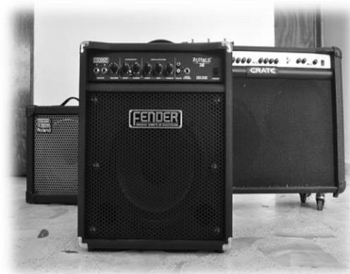
Los amplificadores sirven para aumentar el nivel de la señal; así en cada canal de una mesa de mezclas hay un amplificador para convertir las señales de micrófono al nivel de "línea"; igualmente, para escuchar una señal de líneas hay que enviarla a un amplificador de potencia, que la amplifica a un nivel superior para que pueda mover el cono del altavoz.
