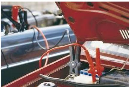
ciclos positivos (la corriente va del polo negativo al positivo) y ciclos negativos (la corriente va del polo positivo al negativo), pues virtualmente da lo mismo que conectes un aparato en cualquier polaridad (ya que, eventualmente, la polaridad se revierte por el proceso de corriente alterna). En un equipo que use corriente directa, por ejemplo en el auto, ahí sí debes cuidar la polaridad porque el diseño de la alimentación
