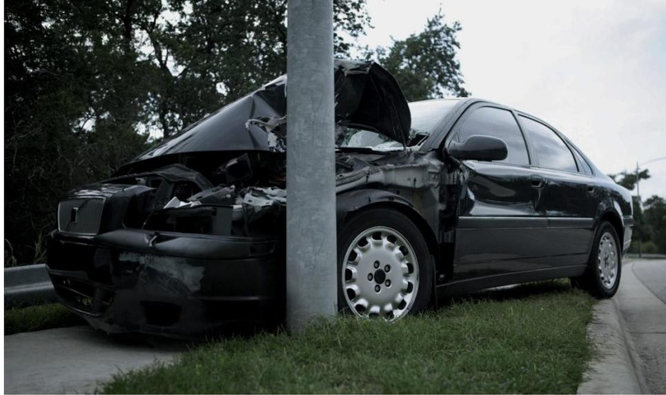
Esto quiere decir que la energía cinética, en general, antes del choque es mayor que la que tiene después. La pérdida de energía que tiene lugar en la colisión se invierte en deformar los cuerpos, en calor o en energía potencial de deformación.
