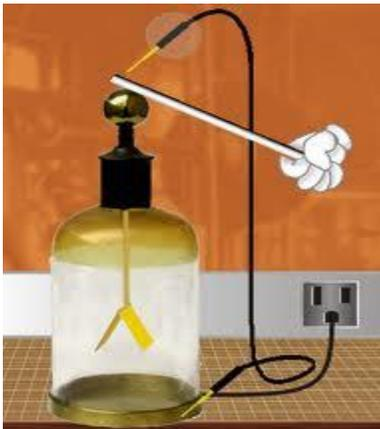
Es un aparato que permite averiguar si un cuerpo está eléctricamente cargado o no lo está. Se compone de una botella de vidrio, un tapón de goma por cuyo centro pasa una varilla metálica que tiene, en uno de sus extremos, una pelotita metálica y en el otro, dos laminitas de oro o platino que, al cargarse, por contacto o por inducción, se repelen (se separan).
