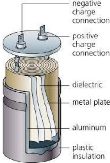
Está formado por un par de superficies conductoras, generalmente en forma de láminas o placas, en situación de influencia total (esto es, que todas las líneas de campo eléctrico que parten de una van a parar a la otra) separadas por un material dieléctrico o por el vacío. Las placas, sometidas a una diferencia de potencial (voltaje), adquieren una determinada carga eléctrica, positiva en una de ellas y negativa en la otra, siendo nula la variación de carga total.
