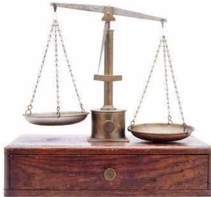
En la versión más elemental consiste en poner de un lado una masa con una medida conocida, por ejemplo una libra, y luego poner en el otro lado, la masa que se quiere medir. La medición estará correcta, cuando los dos platillos estén
