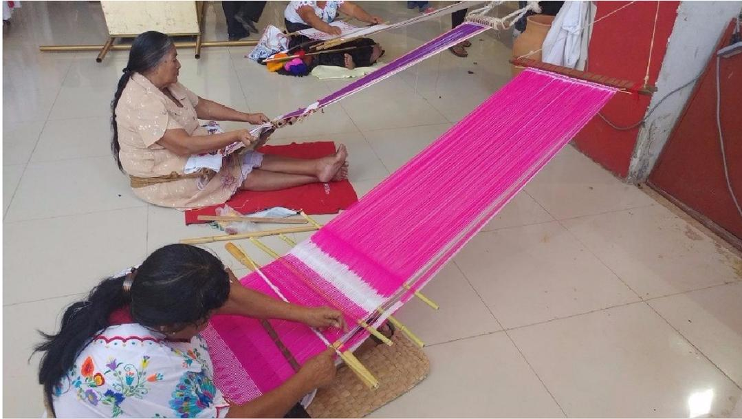
La función esencial de un telar es mantener los hilos de la urdimbre bien tensados y mantenerlos ordenados, para que los hilos de la trama puedan pasar más fácilmente.
