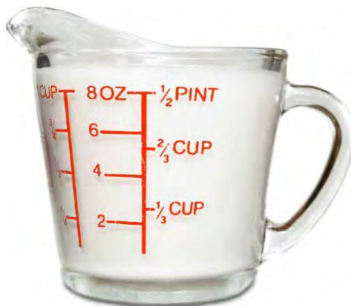
Por diferencia de lecturas: Se mide una determinada cantidad de líquido en un recipiente graduado (observación 1), luego se sumerge el cuerpo cuyo volumen se desea determinar, se observa el nuevo nivel a donde llega el líquido (observación 2) y se calcula la diferencia entre lo anotado en las observaciones 1 y 2. Esta medida constituye el volumen del sólido.
