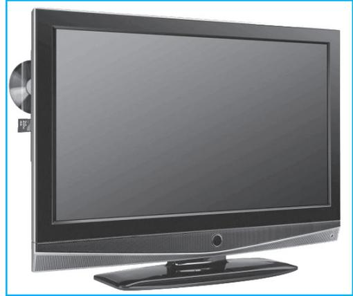
**Pantalla perfectamente plana:** Los paneles de Plasma son totalmente planos, sin ningún tipo de curvatura. Esto elimina la distorsión que se produce en los bordes de la pantalla de los televisores convencionales.
