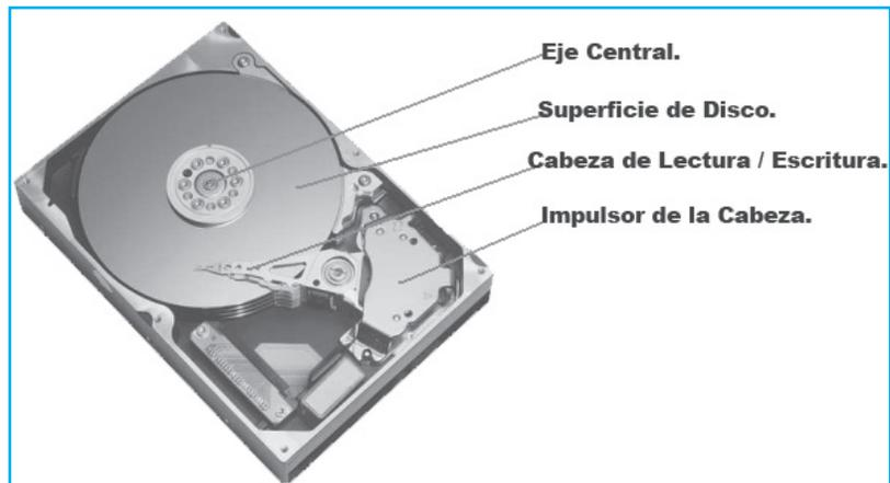
Si alguna de las cabezas llega a tocar una superficie de un disco, causaría muchos daños en él, rayándolo gravemente, debido a lo rápido que giran los discos (uno de 7.200 revoluciones por minuto se mueve a 129 km/h en el borde de un disco de 3,5 pulgadas).
