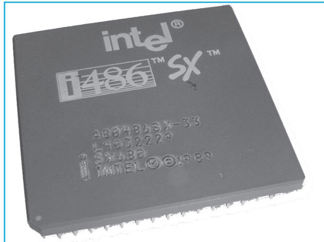
El procesador Intel 486TM fue el primero en ofrecer un coprocesador matemático, el cual acelera las tareas del micro, porque ofrece la ventaja de que las operaciones matemáticas complejas son realizadas (por el co-procesador) de manera independiente al funcionamiento del procesador central (CPU).
