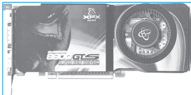
h) **Disipador de calor:** Como muchos chips de video, los chips de memoria de la tarjeta de video alcanzan elevadas temperaturas durante su desempeño. Un disipador de calor ayuda a eliminar mucho la temperatura.
