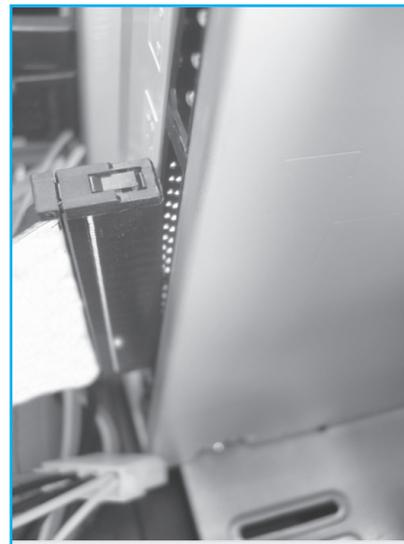
Colocando bus de conexión
