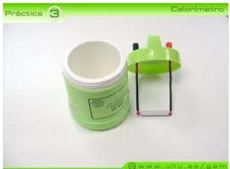
Fue mediante calorimetría, que Joule calculó el equivalente mecánico del calor demostrando con sus experiencias que 4.18 Joule (el joule es una medida de trabajo o energía, como verás más adelante) de cualquier tipo de energía equivalen a 1 caloría.
