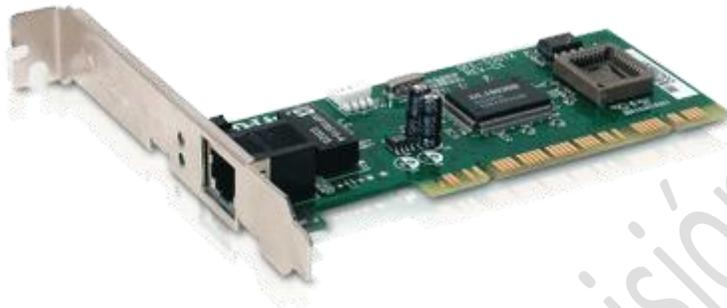
Una tarjeta NIC transmite datos a la red y recibe datos desde la misma. Funciona a nivel del protocolo de enlace de datos. Una tarjeta de red proporciona un punto de unión para un tipo específico de cable, tales como cable coaxial, cable de par trenzado, o cable de fibra óptica. Las tarjetas de interfaz para redes inalámbricas tienen típicamente una antena para la comunicación con una estación base. Cada tarjeta de interfaz de red tiene una dirección IP única.
